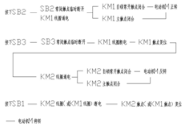
图3 按钮互锁工作原理
