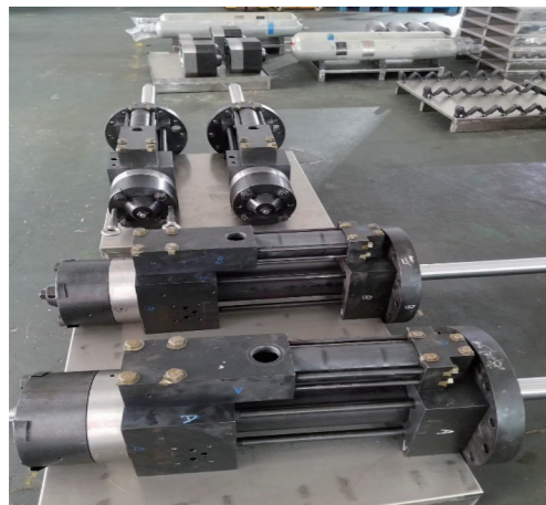
燃机专用阀门维修
